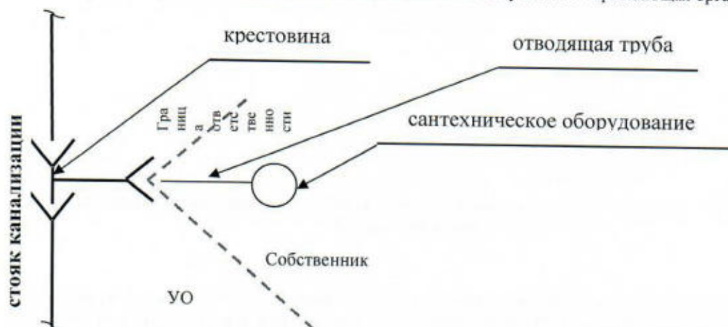
Граница раздела обслуживания по канализации между Управляющей организацией и Собственником помещений
